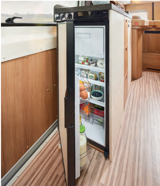
▲ Der leistungsstarke 84-l-Kompressorkühlschrank ist im Eingangsbereich an der Küchenstirnseite integriert. Somit ist er sowohl von innen als auch von außen bequem zugänglich.
