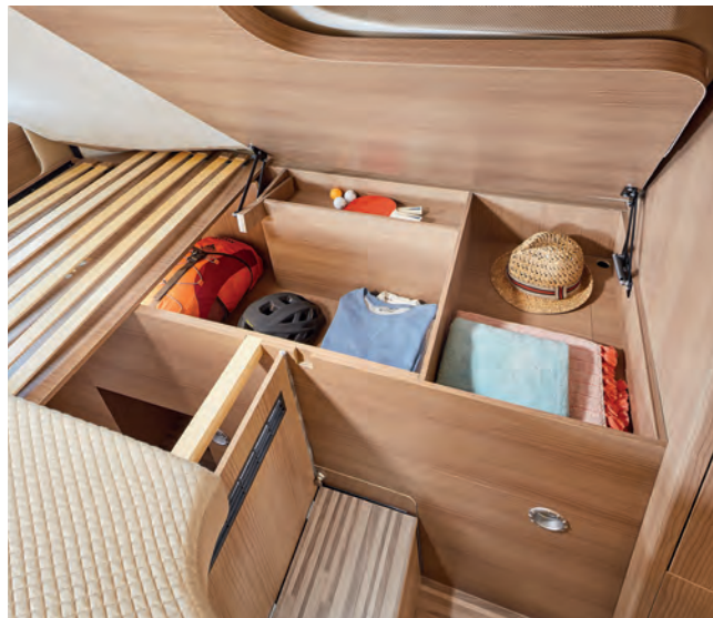
▲ Der Wäscheschrank unter dem Längseinzelbett auf der Fahrerseite ist dank eines Klappmechanismus bequem zugänglich.
