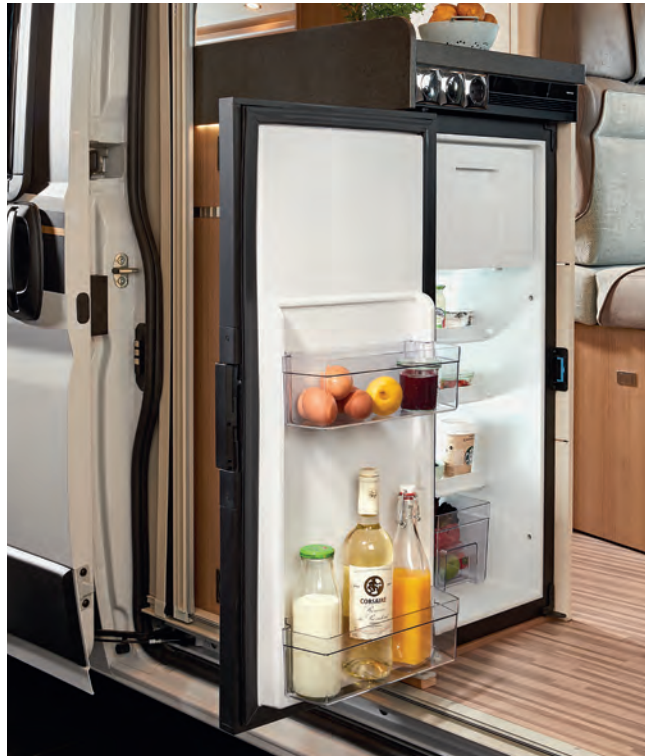
▲ Der leistungsstarke 84-l-Kompressorkühlschrank ist im Eingangsbereich an der Küchenstirnseite integriert. Somit ist er sowohl von innen als auch von außen bequem zugänglich.
