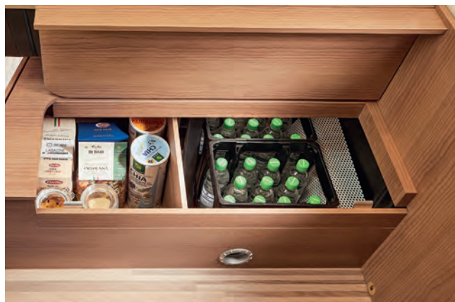
▲ Komfortabler Zugang in den Stauraum der Sitzbanktruhe von oben mittels "Ein-Handgriff-Zugang", ohne aufwendige Entnahme der Polster.
