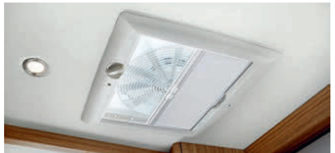
9403 Frischluftventilator über Küche
