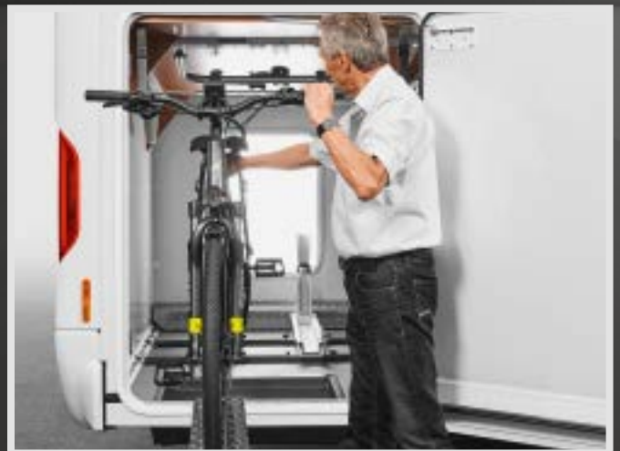
▲ Erweiterung der Beladungshöhe durch einfaches Hochschwenken des innenliegenden Heckbetts mit einer Hand und zusätzlicher, abgesenkter Bodenmulde (somit Lenkerhöhe bis 124 cm möglich)
