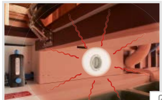
▲ Wärmespeicher-Heiztechnik Truma Combi 6 mit Wärmeluftauslässen im gesamten Doppelboden-Keller, im Wohnraum, in der Heckgarage, im Fahrerhaus und in den kältesensiblen Türeinsteigen
