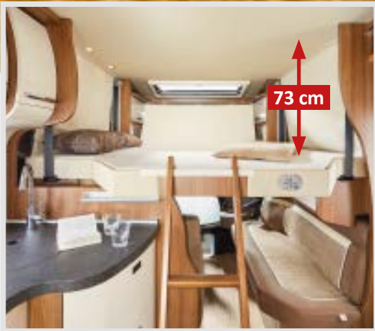
▲ Optionales Zentral-Hubbett: elektrisch bedienbar, große Liegefläche, Stehhöhe unter Bett im Wohnzustand 184 cm
