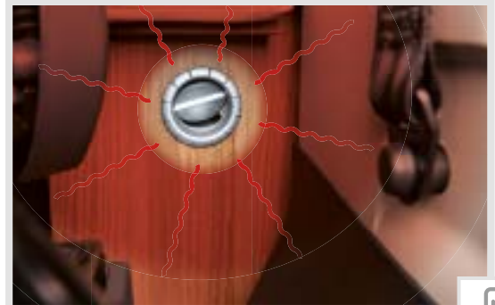
▲ Gezielte Beheizung des Fahrerhausbereichs durch beheizten Armaturenbrettvorbau und zusätzliche Warmluftauslässe
