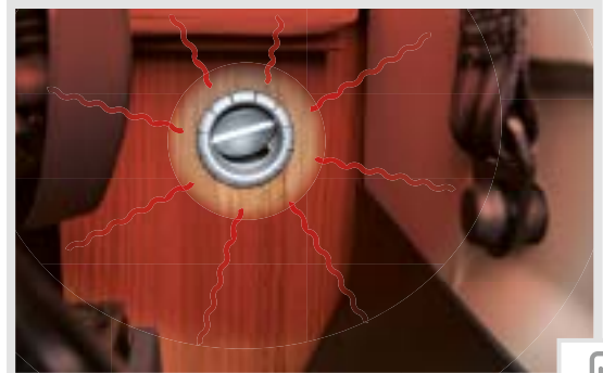
▲ Gezielte Beheizung des Fahrerhausbereichs durch zusätzlichen Wärmeluftauslass unter Fahrerhausssitz.
