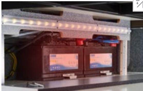
**Batteriezentrale Serie:** 2 x 80 Ah Gelbatterien in beheiztem Doppelboden-Keller und Batterie Hauptschalter, optional Lithium-Ionen-Batterie 90 Ah inklusive Batteriecomputer
