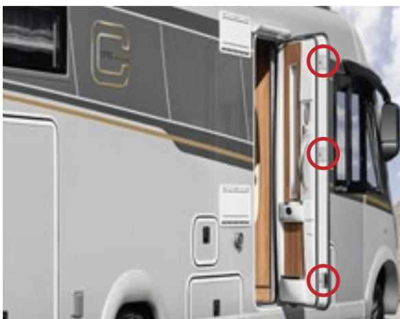
mit dreifacher Verriegelung, innenliegenden Stahlscharnieren, Türfenster mit Fliegenrollo (Super Paket)
