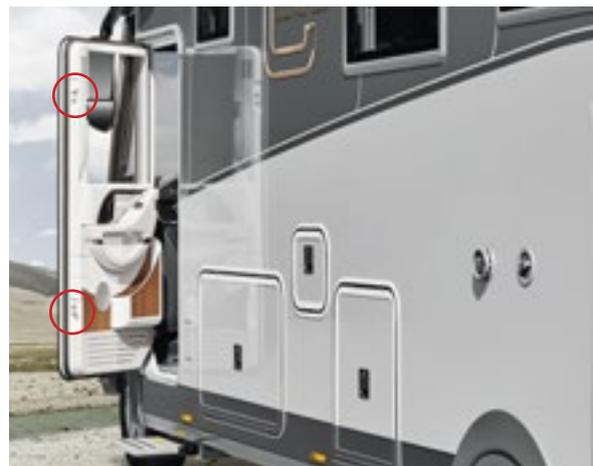
mit Sicherheits-Doppelverriegelung, elektrischem Fensterheber und niedrigem Türeinstieg
