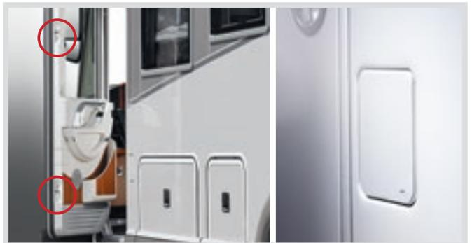
Fahrertür mit extraniedrigem Türeinsteig und Sicherheits-Doppelverriegelung. Kraftstoff-Tankdeckel flächenbündig in Seitenwand eingelassen
