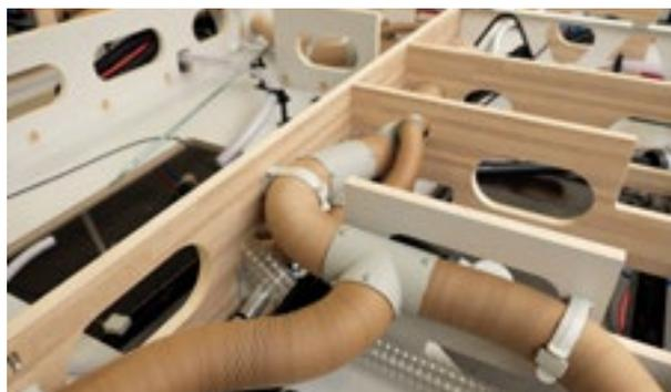
Der Carthago Doppelboden trägt mit der selbsttragenden Karosserie und dem AL-KO Tiefrahmen speziell zu einem Höchstmaß an Stabilität und Torsionssteifigkeit bei
