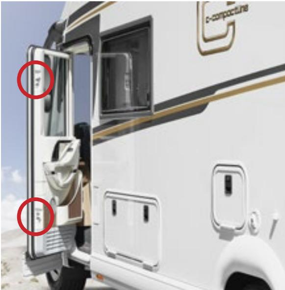
mit Sicherheits-Doppelverriegelung, elektrischem Fensterheber und niedrigem Türeinstieg
