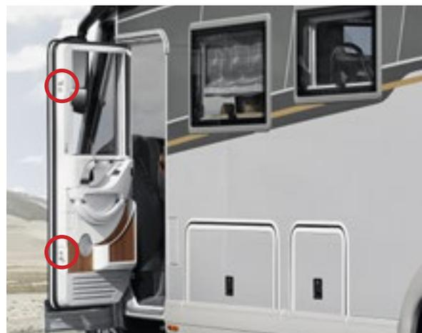
mit Sicherheits-Doppelverriegelung, elektrischem Fensterheber und niedrigem Türeinstieg
