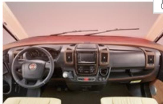
**Zusätzliche Beheizung des Fahrerhausbereichs** durch beheizte Armaturenbrettoberfläche, damit Reduktion der Kälteabstrahlung durch die Frontscheibe in den Fahrerhaus-/Wohnraumbereich (bei Alde-Warmwasser-Heizung durch Heizkonvektoren).
