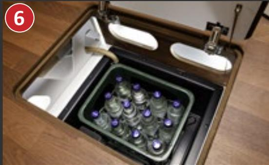
6 Wohnraumbodenklappe mit Doppelboden-Staubox (42 cm Nutztiefe), im beheizten Doppelboden
