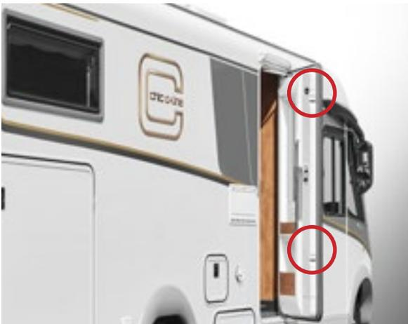
mit Sicherheits-Doppelverriegelung, Türbegrenzer, Türfenster und Fliegengitterrollo
