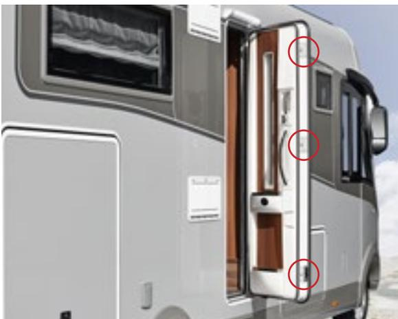
mit dreifacher Verriegelung, innenliegenden Stahlscharnieren, Türfenster mit Fliegenrollo (Super Paket)
