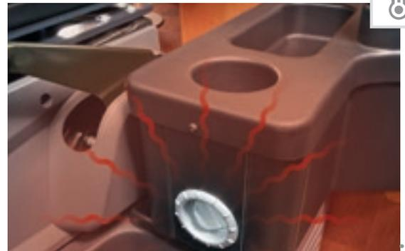
**Wärmespeicher-Heiztechnik Truma Combi 6** mit zahlreichen Warmluftauslässen im gesamten Doppelboden-Keller, im Wohnraum, in der Heckgarage, im Fahrerhaus und in den kältesensiblen Türeinsteigen
