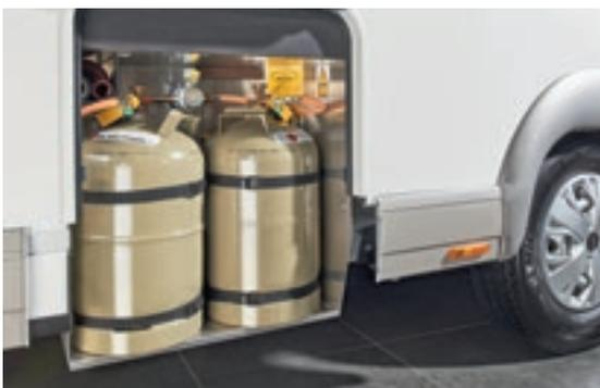
**Gasflaschenkasten „easy change“**, tief abgesenkt, Einhandbedienung der Klappe, bequemes Tauschen der einzeln zugänglichen Gasflaschen
