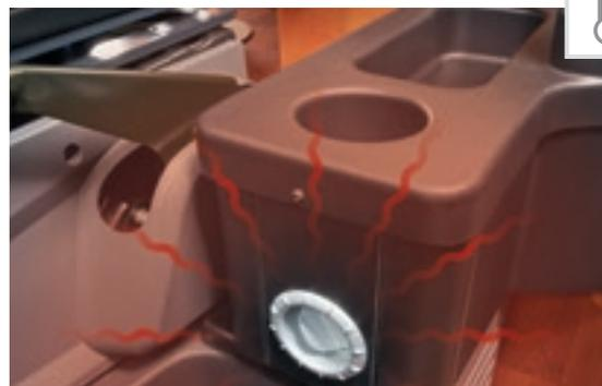
**Wärmeluftspeicher-Heiztechnik Truma Combi 6** mit zahlreichen Wärmeluftauslässen im gesamten Doppelboden-Keller, im Wohnraum, in der Heckgarage, im Fahrerhaus und in den kältesensiblen Türeinbauten
