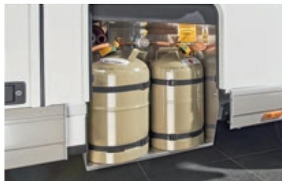
**Gasflaschenkasten „easy change“**, tief abgesenkt für ein bequemes Austauschen der Flaschen, beide Flaschen einzeln zugänglich
