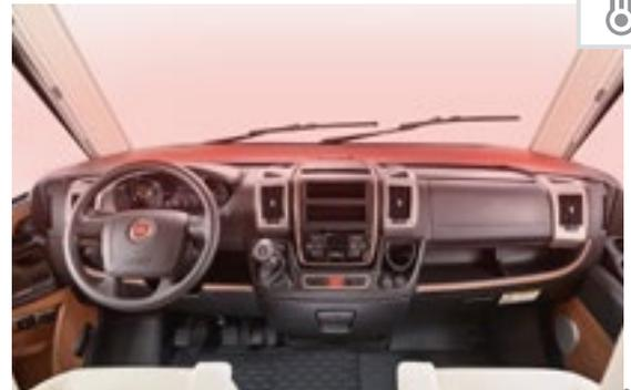
**Zusätzliche Beheizung des Fahrerhausbereichs** durch beheizte Armaturenbrettoberfläche, damit Reduktion der Kälteabstrahlung durch die Frontscheibe in den Fahrerhaus-/Wohnraumbereich
