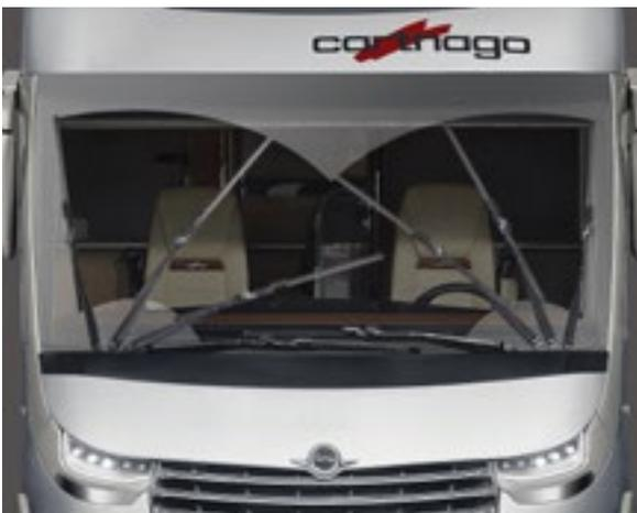
Abblend- und Fernlicht inkl. Tagfahrlicht mit LED-Lichtleiter für perfekte Ausleuchtung und hervorragende Sicht; zusätzlich bei Iveco Daily: gegenläufige Buswischeranlage
