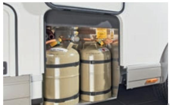
**Gasflaschenkasten „easy change“**, tief abgesenkt für ein bequemes Tauschen der Flaschen, beide Flaschen einzeln zugänglich (nicht I 141 LE, I 143 LE)
