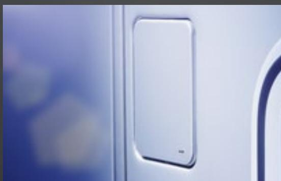
**Die Tankklappe** ist bei den Carthago Integrierten flächenbündig verbaut.
