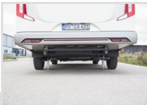
Carthago vertraut innovativer AL-KO Technologie wie z.B. dem AMC-Chassis mit Drehstabfederung und Einzelradaufhängung für mehr Komfort und Sicherheit sowie der hochfesten und feuerverzinkten AL-KO Leichtbautechnologie für mehr Stauraum und mehr Zuladung. Aber auch den innovativen und modernen hydraulischen Stützen und Luftfederungssystemen mit intuitiver Bedienung.
