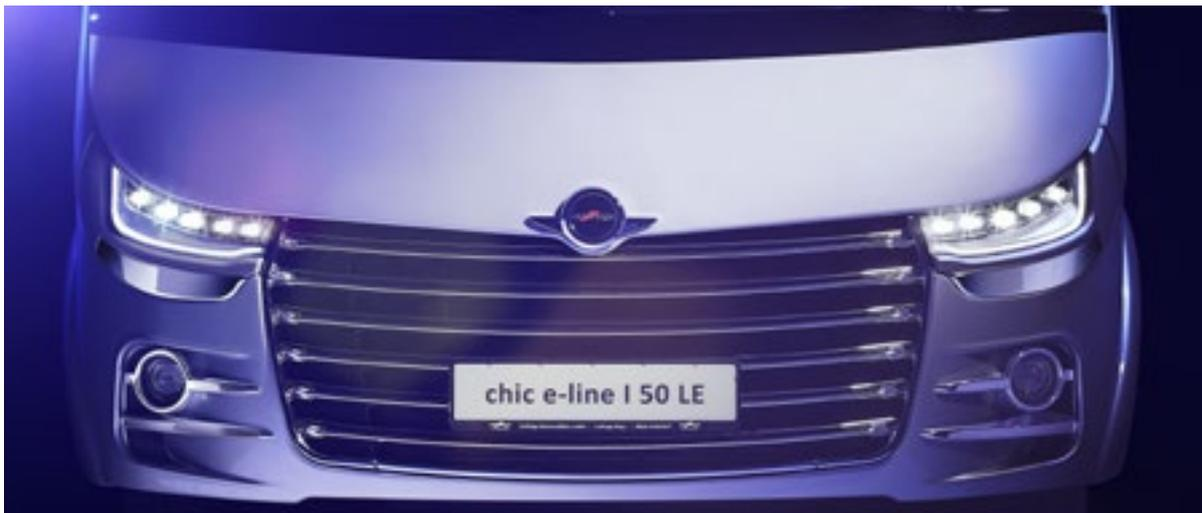
mit Abblend- und Fernlicht inkl. Tagfahrlicht mit LED-Lichtleiter – ermüdungsfreies Fahren auch bei Dämmerung und in der Nacht durch optimale Fahrbahnausleuchtung
