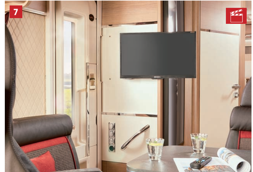
7 Schwenkbares TV-Haltersystem für bequemes Fernsehen auf Sichthöhe.
