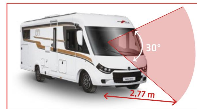
! Testbestwert für die Sicht auf die Fahrbahn nach nur 2,77 m
