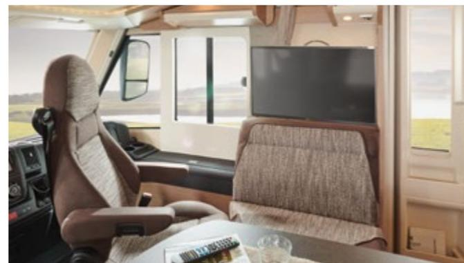
**!** 32"-LED-Flachbildschirm mit Quick-up-System hinter Seitensitz (Optional für I 490 LE/500 QB)
