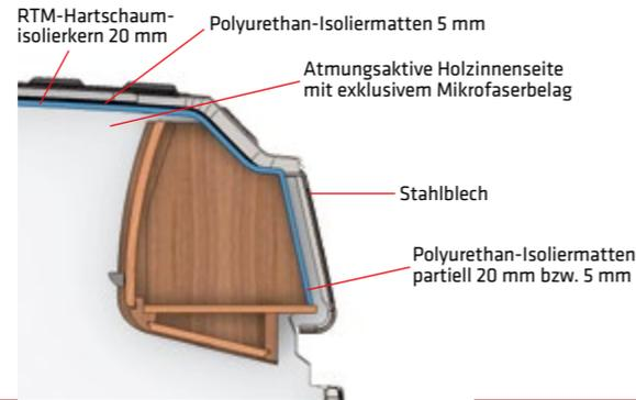
**!** Aufwendige Karosserie-Isierungsmaßnahmen: Bodenplatte & Deckenpaneel mit RTM-Hartschaum-Isolierkern. RTM hat eine lebenslange wirksame Isolation, ist wasserabweisend & nimmt somit keine Feuchtigkeit auf. Damit schützt es vor Hitze und isoliert gegen Kälte, gleichzeitig werden Fahr-Nebengeräusche reduziert.
