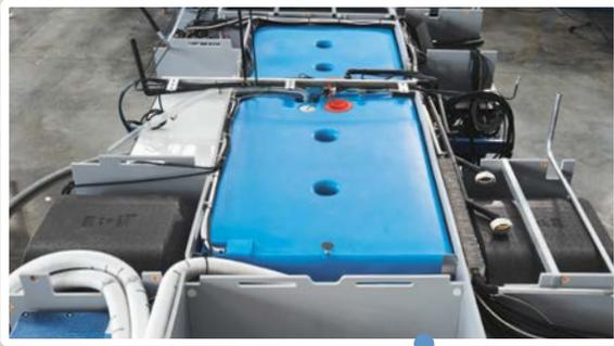
Für eine optimale Achslastverteilung sind die Gewichte der Installationen im Doppelboden genau richtig verteilt, so liegen zum Beispiel die beiden großen Wassertanks zentral auf der Hinterachse.
