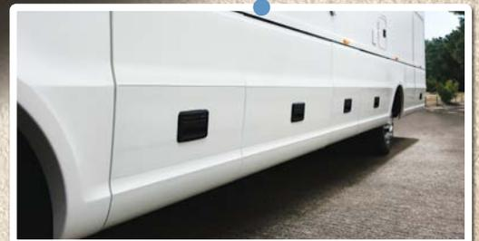
Die aufwändig geformten Seitenschürzen aus lackierten Aluminiumprofilen verleihen dem Flair ein sportliches Außendesign. Sie verdecken Chassisrahmen und die eingefahrene Außentrittstufe.
