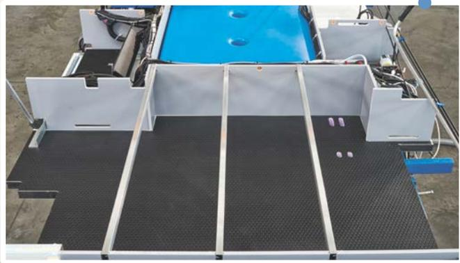
Der Unterboden in Verbindung mit der Laufbodenplatte sorgen für eine hohe Steifigkeit des Fahrgestells und damit für sehr gute Fahreigenschaften. Zudem reduziert die Isolation durch 2-sided-Aluminium die Fahrgeräusche im Boxaufbau auf ein Minimum.
