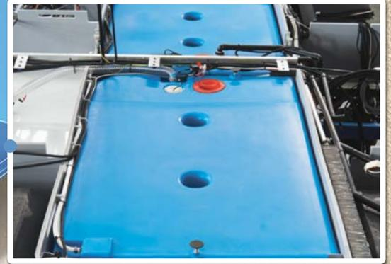
Die großen Wassertanks können auch bei Minustemperaturen nicht einfrieren, denn sie liegen im beheizbaren Doppelboden, isoliert mit 2-sided Aluminium-Sandwich. Die Wassertanks lassen sich durch die Heckgarage herausnehmen und austauschen.
