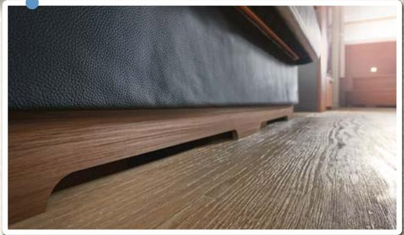
Heizkonvektoren im Doppelboden schützen alle Installationen vor Kälte. Gleichzeitig dient der Doppelboden als Wärmespeicher und gibt die Wärme ähnlich einer Fußbodenheizung an den Laufboden ab. Als weiteres Extra ist optional eine voll funktionsfähige Fußbodenheizung erhältlich.
