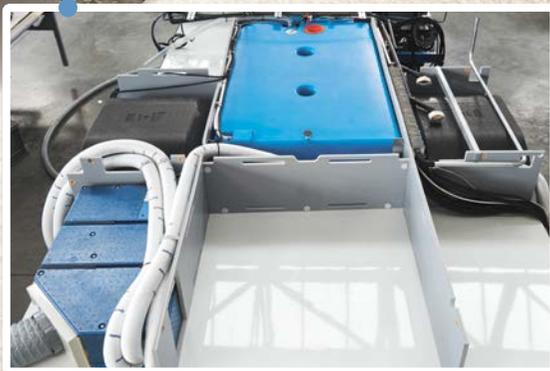
Der Unter- und Laufboden sind komplett aus 2-sided-Aluminium-Sandwich gefertigt. Dieser Doppelboden dient somit als Wärmespeicher, wodurch der Innenraum des Fahrzeuges besonders gut isoliert ist.
