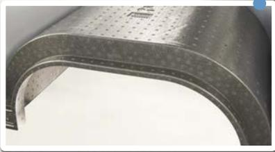
Die Isolation der hinteren Radkästen mit expandiertem Polypropylen sorgt für eine besonders gute Schall- und Kälte­dämmung.
