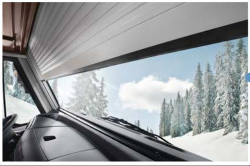
Für die große Panoramasscheibe mussten wir uns etwas Besonderes einfallen lassen. Die gibt es nämlich nicht mit Doppelverglasung. Damit die Kälte aber auch hier draußen bleibt, kann man das elektrisch bedienbare isolierte Frontrollo (optional) einsetzen. Der Zwischenraum wird zusätzlich direkt beheizt.
