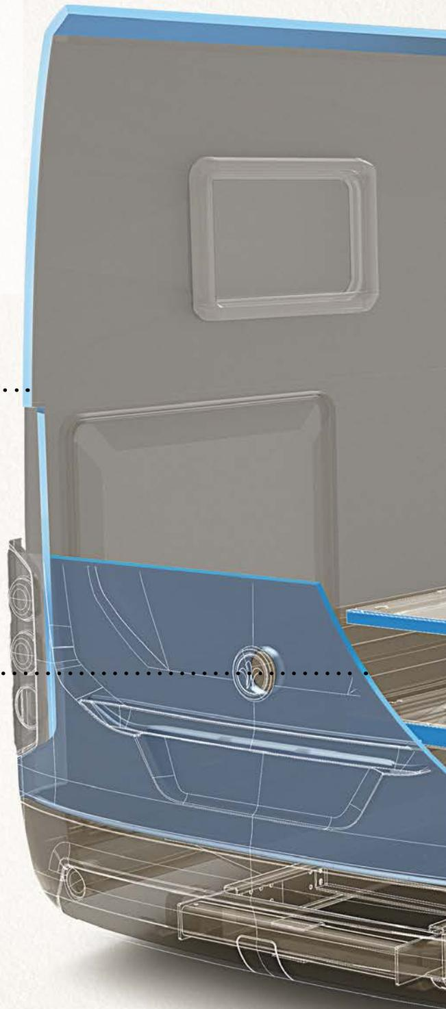
Auch die Verbindung zwischen Dach und Seitenwand ist durch 2-sided-Aluminium kältebrückenfrei.
