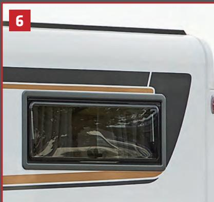
6 **Aufbaufenster Seitz S4** mit kältebrückenfreiem PU-Rahmen und Isolierverglasung.
