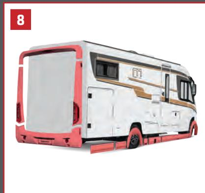
8 **Überarbeitetes Heckdesign** mit fließendem Übergang in die Dach- / Seitenwandrundung, Reparaturfreundlichkeit im Schadensfall dank 4-teiligem Heckrahmen.
