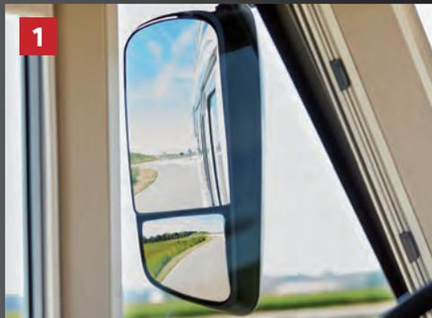
1 **Beste Rundumsicht** durch Busrückspiegel mit großem Haupt- und Weitwinkelspiegel.
