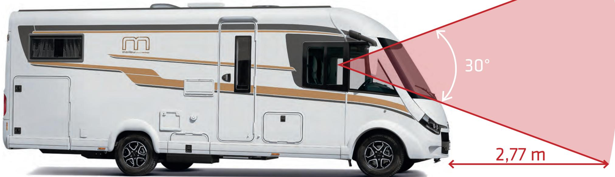
▲ Fahraktives, extratief abgesenktes Armaturenbrett für frühen Fahrbahnsichtkontakt und tief angesetzte Panoramafrontscheibe. Testbestwert für Sicht auf die Fahrbahnoberfläche nach nur 2,77 m. Außerdem weniger Luftwiderstand, Kraftstoffverbrauch und Windgeräusche dank der dreidimensional geformten Front und dem flachen Anstellwinkel.
