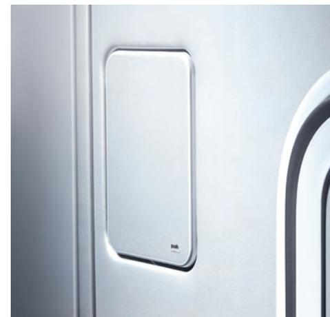
▲ Kraftstoff-Tankdeckel flächenbündig in die Seitenwand eingelassen.
